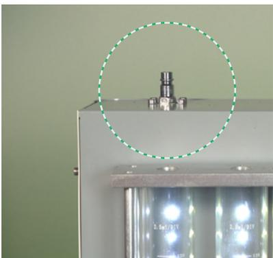
Выкрутите заглушку и установите пневматический адаптер подключения подачи воздуха.
