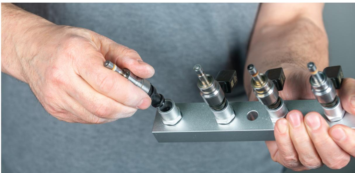
4. Установите необходимые заглушки из набора в каналы распределителя топлива, которые не используются (зависит от количества проверяемых форсунок).
